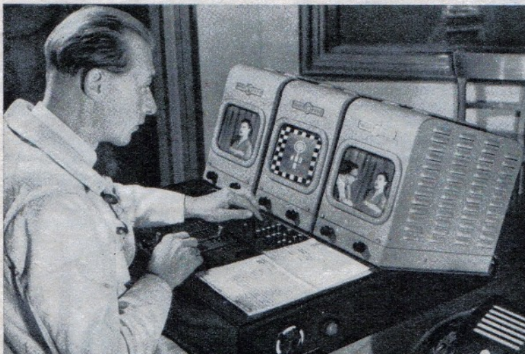
Das übersichtliche Bildmischpult der Fernseh GmbH enthält Kontrollgeräte für die beiden Aufnahmekameras und wahlweise für die Filmgeber oder den Dia-Bildgeber
