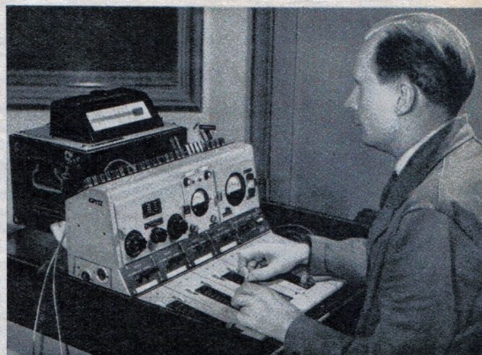
Am Tonmischpult lassen sich alle 4 Einzelverstärker und die abgehenden Leitungsverstärker überwachen. Aufnahmen: E. Schwahn
