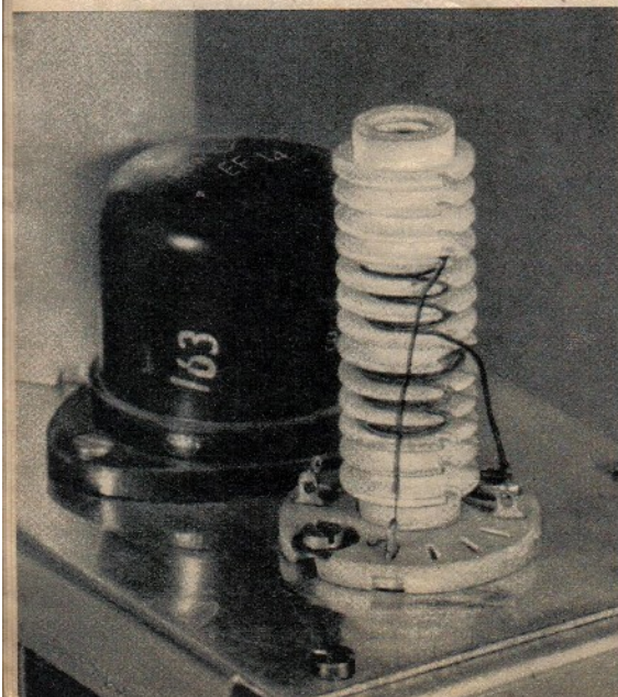
Abb. 19. Der erste Spulenkörper des Bild-ZF-Kanals enthält oben die Wicklung L5 und unten L6. Man erkennt, daß die Spulen wie auch auf den anderen Körpern jeweils in drei Kammern (=eine Kernlänge) verteilt ist. Stehen nur kleinere Kammerkörper zur Verfügung, so kann man hier zwei gleichartige Spulenkörper axial übereinander kleben
